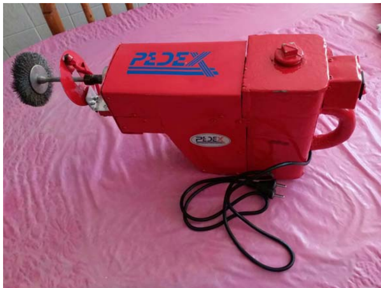
شکل ۳) نمونه آزمایشی ساخته شده ی دستگاه شستشوی پین و باکس لوله های حفاری
